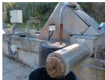
Il·lustració 11: Fangs primaris compactats – Font pròpia
